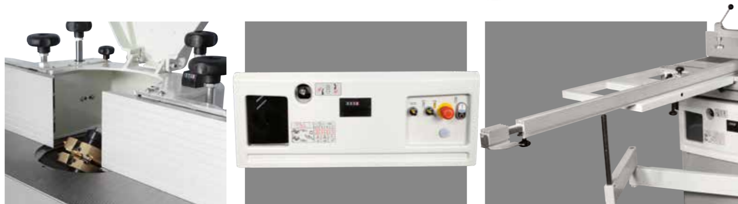
Tilting spindle 90 ÷ 45°. Arbre inclinable 90 ÷ 45°.
