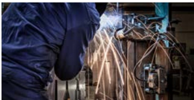
Soudage à la main d'un bâti
