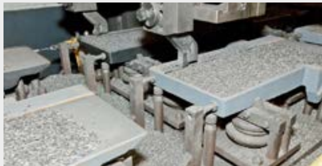
Rectification de tables en fonte
