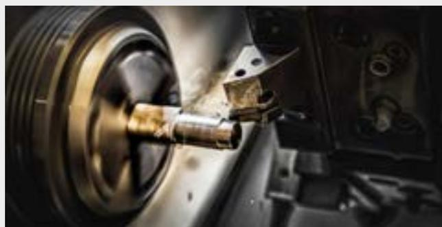
Usinage CNC d'une pièce en acier
